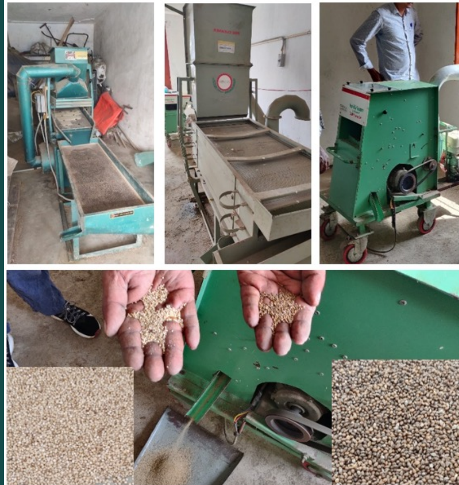
Machines créées par la DHAN pour la transformation du millet brut (sombre) en riz de millet (clair)
