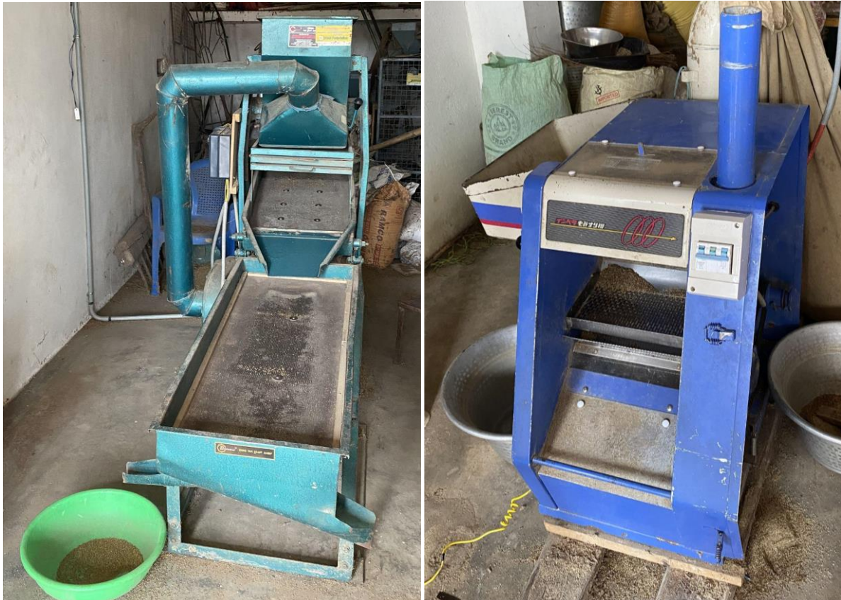
Photographie 32 : L'épierreuse-niveleuse à aspiration (gauche) et le décortiqueur (droite) de l'unité de Verappanur (Jawadhu Hills) © Lucille Lahaye, mars 2023
