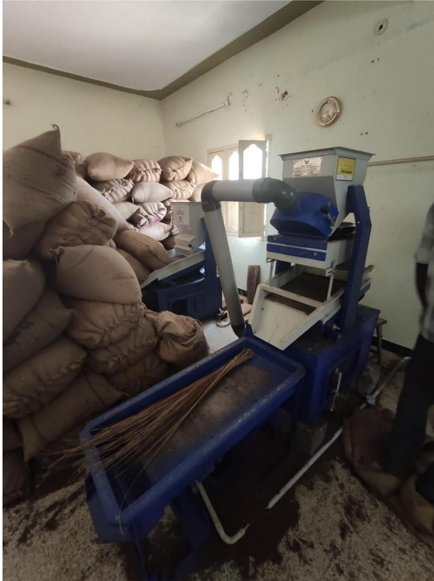
Figure 29 : Machine à équeuter le millet.
